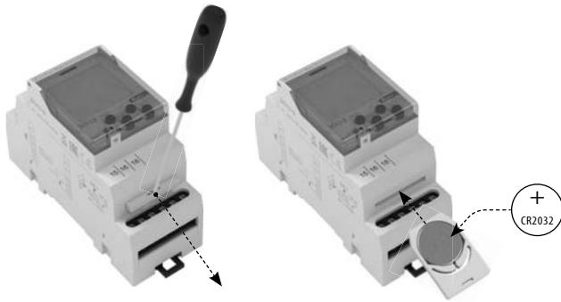
Замена батареи производится без демонтажа устройства.
